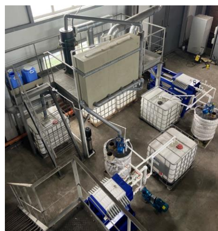
Рис. 6. Принципиальная схема и внешний вид опытной установки химического восстановления углеродного остатка пиролиза отработанных шин
