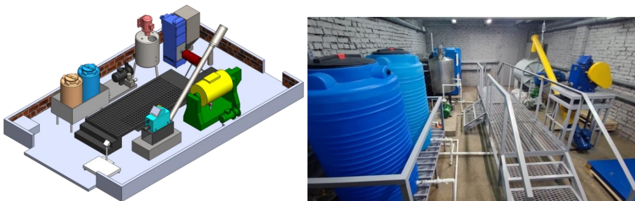
Рис. 1. Пилотный стенд для воспроизведения условий, соответствующих энергетическим установкам для термической конверсии сырья
