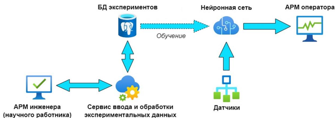
Рис. 8. Схема применения нейросетевых алгоритмов для получения требуемого компонентного состава топлива из совокупности компонентов с учетом заложенных результатов мультикритериального анализа
