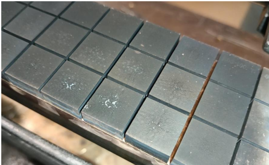
Рисунок 5 – Поверхность бериллиевых плиток после 30000 циклов при 4,7 \text{ МВт/м}^2
