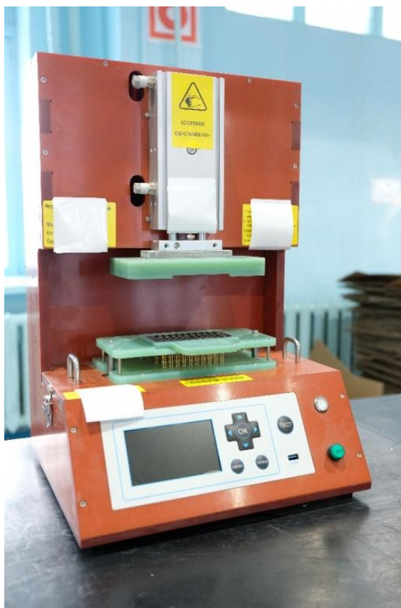
Рисунок 5 – Внешний вид устройства проверки модулей воспламенителей с электронным замедлением.
