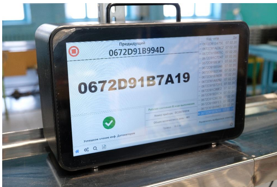
Рисунок 7 – Внешний вид устройства для считывания индивидуального номера электронного детонатора и печати этикетки.
