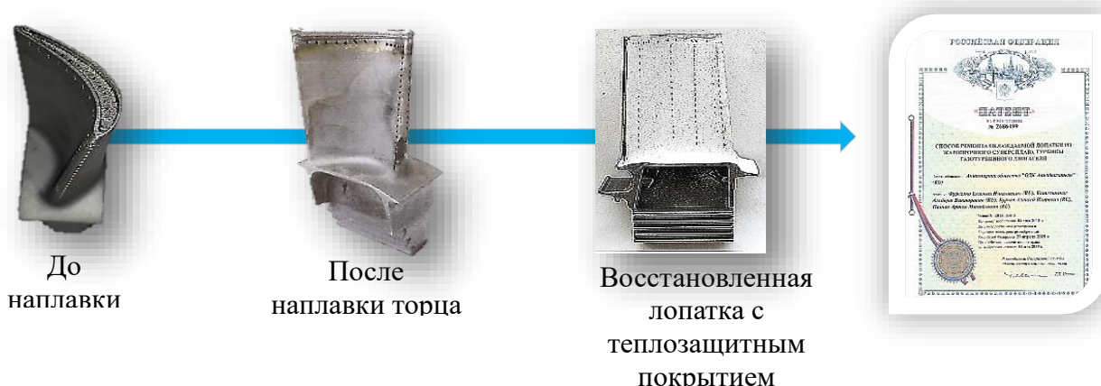
Рисунок 3 – Внешний вид восстановленной РЛ 1 ступени ТВД
