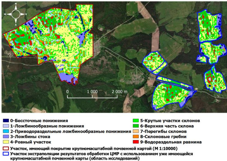
Рис. 2. Результат классификации рельефа области исследований по методу SAGA TPI Based Landform Classification на участок, имеющий покрытие крупномасштабной почвенной картой (ПХ «Восход») и участок исследований (ООО «Сельское»)
