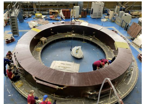
Рисунок 6 - Участок намотки секций обмотки в «чистой комнате»
