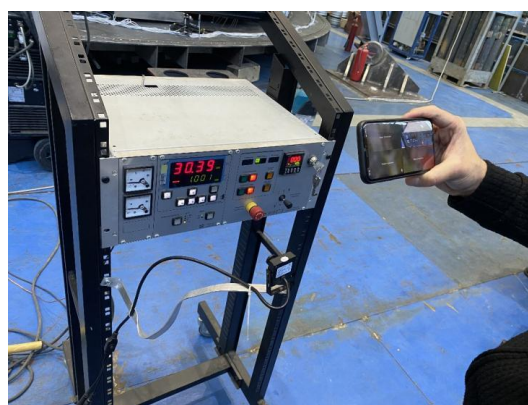
Рисунок 9 – Высоковольтные испытания напряжением до 100 кВ, включая испытания по кривой Пашена
